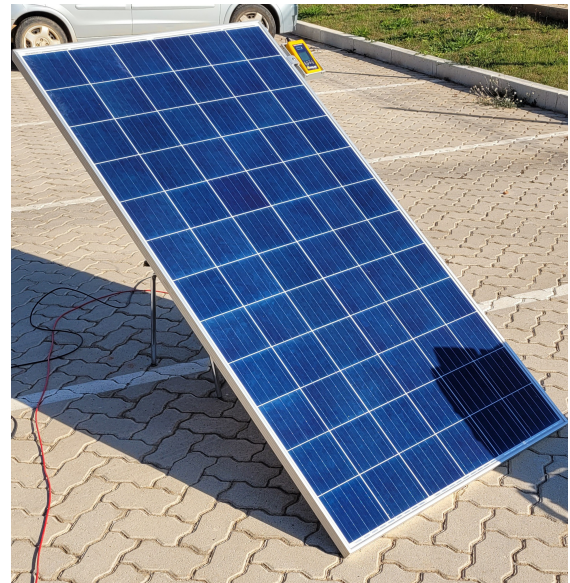
Figura 12. Módulo sob condição de sombreamento parcial.
