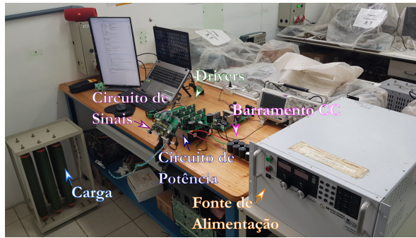
Figura 17. Setup de testes do protótipo de 1,5 kW implementado do inversor ANPC-5L-MSSC.
