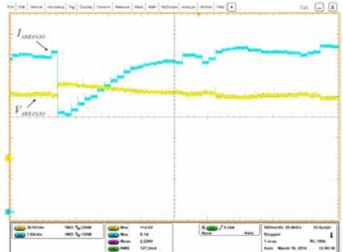
Fig. 11. Ensaio com degrau positivo de carga. Escalas – CH1 (amarelo): 30 V/div; CH2 (azul): 1 A/div; tempo: 500 ms/div.
