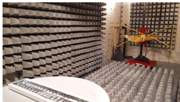
Fig. 4. Visão da luminária e da antena utilizada nos ensaios
