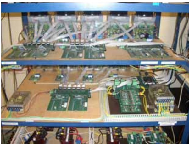
Fig. 16. Protótipo do conversor multinível – Detalhe: Placas de medição, condicionamento e controle.
