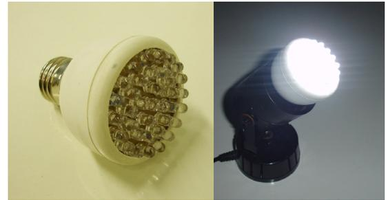
Fig. 11. Protótipo da lâmpada com 36 LEDs.
