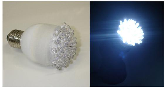
Fig. 10. Protótipo da lâmpada com 49 LEDs.
