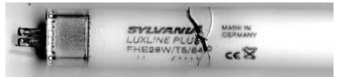
Fig. 11. Lâmpada T5 danificada por aquecimento excessivo da base.
