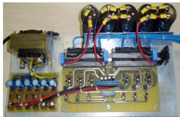
Fig. 17. Foto do circuito de acionamento do GRV e conversor Half-Bridge (IGBT 600V/100A)
