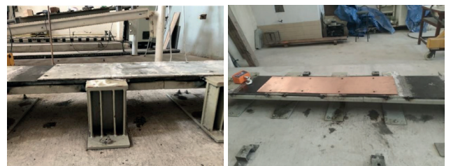
Fig. 13. Back-iron com preenchimento e folhas de Alumínio (esq.) e Cobre (dir.).
