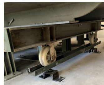
Fig. 6. Estrutura com rodas de guiamento e suporte: fácil mas com resultados incompletos.
