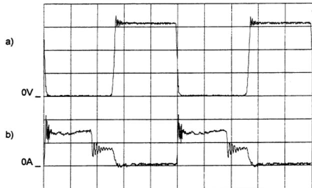
Figura 23. Chave  $T_i$ : a) tensão (100V/div); b) corrente (10A/div). Escala horizontal: 2#s/div
