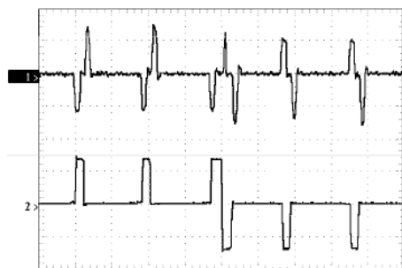
Figura 22. 1- Corrente no indutor ressonante (5A/div); 2- Tensão de saída três níveis no inversor (150V/div)
