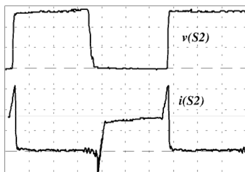
Figura 16: Comutação com tensão nula em S2. Escala: Tensão = 100 V/div; Corrente = 5 A/div; Tempo = 2 \mu s /div
