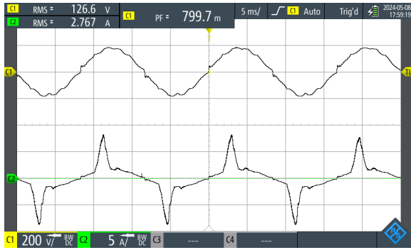
FIGURA 15. Formas de onda obtidas experimentalmente com carga não linear. Escala de corrente: 5A/div. Escala de tensão: 200V/div.
