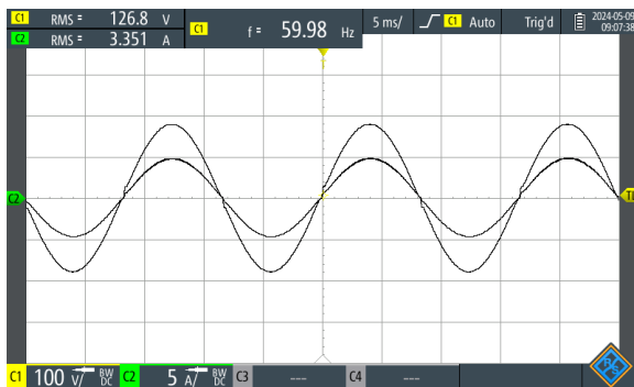
FIGURA 12. Formas de onda da tensão e corrente de saída para uma carga resistiva. Escala de corrente: 5A/div. Escala de tensão: 100V/div.
